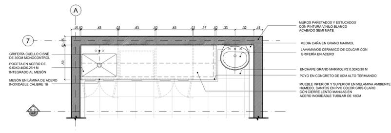
PLANTA DETALLE MUEBLE TIPO / D - 01 / A-A' ESC.....1:25
